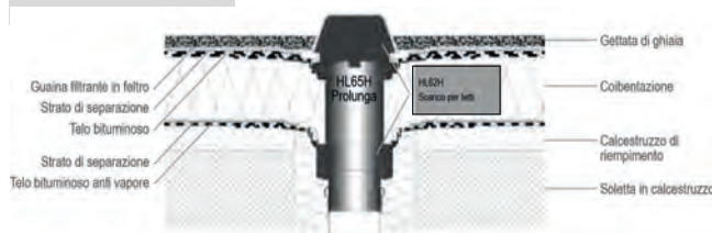
TETTO COIBENTATO CON GETTATA DI GHIAIA
